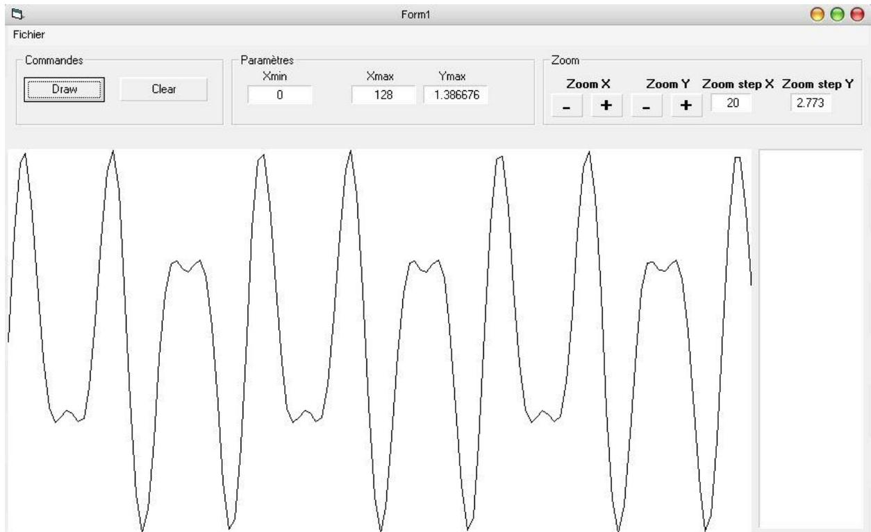
$A_0 \cdot \sin(2\pi \cdot F_0 \cdot t) + A_1 \cdot \sin(2\pi \cdot F_1 \cdot t)$  avec  $A_0$ ,  $A_1$  les amplitudes et  $F_0$ ,  $F_1$  les fréquences des signaux.
